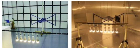
電波暗室と反射箱におけるLED照明から放射される電磁雑音の測定風景
